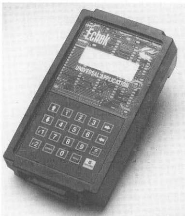
Las herramientas electrónicas como el Compulink™ y Echeck™, ofrecen diagnósticos sofisticados para ayudar a los técnicos a eliminar los costos y tiempo innecesario que el motor esta fuera de operación.
