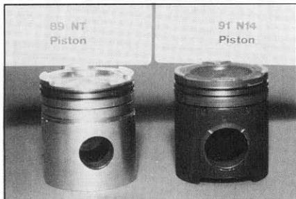
motores considerados superiores, como el 460E. Esto consiste en un tratamiento de la superficie, el cual incrementa la fuerza del metal con el fin de prevenir fisuras y le da un color gris oscuro al pistón. Este nuevo pistón es capaz de resistir fisuras, corrosión y soportar temperaturas más altas que son producidas por el alto torque de éstos motores. Este diseño anodizado incrementó el enfriamiento del pistón, resultando en mayor durabilidad del pistón. Los
