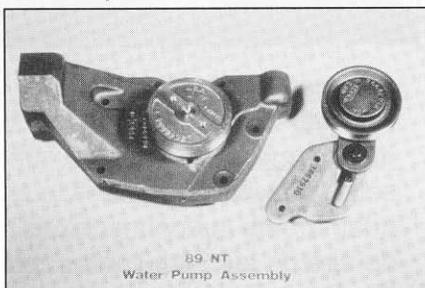
un nuevo cuerpo de fundición, impulsor de bomba de agua, rodamiento reforzado y engrasado al vacío. La polea de la bomba de agua es semejante a la del BCIII con una banda "poly vee".
