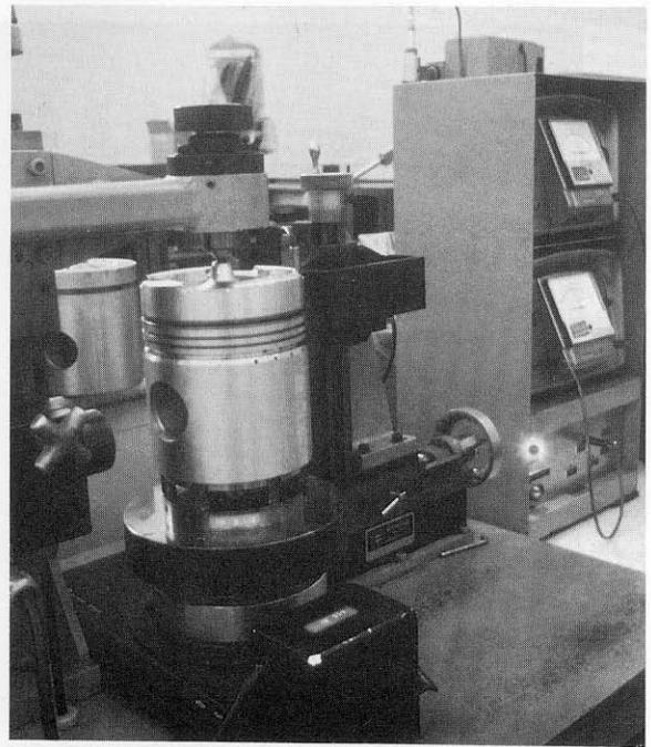
estos castillos junto con la corona del pistón. Esto proporciona un espacio preciso entre la válvula y el pistón. Esto asegura que la compresión sea correcta. Un maquinado impropio en los castillos lleva a baja compresión, resultando el comienzo de muchos problemas.
