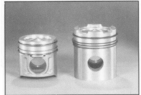
Los motores L10 disponen de un pistón de cabeza plana, es decir que ésta carece de huecos para las válvulas. La falda del pistón presenta el singular acabado "CeCorr" que mejora la retención del aceite y brinda más protección durante el arranque en frío. El bulón hueco de gran diámetro utilizado en el L10 confiere más resistencia. Por otra parte, el rectificado especial aplicado al pistón garantiza la perfecta adaptación de éste a la pared del cilindro.
