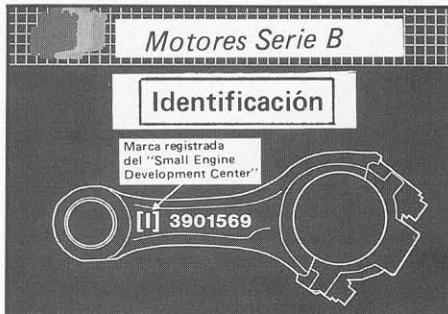
Otro punto importante a recordar es que las piezas principales de los motores Series B y C se identifican por una **marca registrada** que garantiza la **autenticidad** de la pieza. Las siglas "**CDC**" indican que la pieza proviene del "Cummins Engine Development Center". Dicha marca se encuentra en las bielas, bloque, cigüeñal, árbol de levas, pistones y culatas. Si esta marca no se halla presente, se trata con toda probabilidad de una pieza posmercado.
