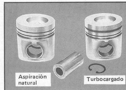
Una similitud que comparten todos los pistones de los motores Serie B y C es que cuentan con un pasador "flotante" y no de ajuste forzado. Ello se debe a que el pistón y su pasador soportan cargas más reducidas y el
