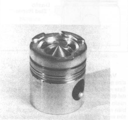
Los pistones "Dual Ni-Resist" hicieron su debut en los Motores NH/NT correspondientes a la serie 30, que funcionan con carga elevada y pocas RPM. También constituirán una "característica" de la mayoría de los nuevos modelos NT. La versión "Dual Ni-Resist" es standard en el modelo NTC-444.
