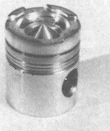
Debido a las enormes presiones desarrolladas por los motores diesel, los dos segmentos superiores ejercen un fuerte impacto contra sus ranuras. A fin de contrarrestar el desgaste provocado por esta acción, la ranura correspondiente al primer segmento y, en algunos casos, la del segundo, disponen de un aditamento "Ni-Resist" realizado en aleación de níquel, resistente al calor, erosión y desgaste. Ver Tema de Servicio/Piezas 86T 1-9A.
