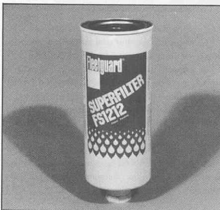
El SUPERFILTER de Fleetguard reúne el separador de agua y el filtro de combustible en una sola unidad de alto rendimiento. Los Superfilters eliminan el agua "libre" con un 99% de eficiencia y eliminan el agua emulsionada del combustible con un 94% a 99% de eficiencia. Una válvula de autoventilación patentada permite un drenaje fácil y rápido.
