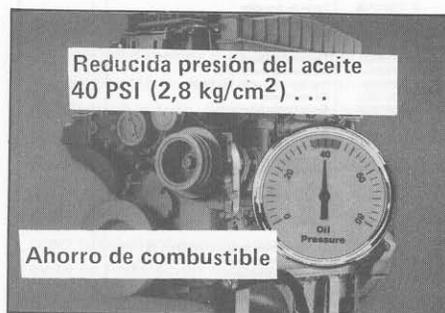
Las bombas de lubricación anteriores a la DFC estaban previstas para suministrar más aceite y presión de los que realmente necesitaba el motor. En cambio, el sistema de regulación DFC mantiene una presión nominal de aceite de aproximadamente 40 libras por pulgada cuadrada (40 psi = 2,8 kg/cm<sup>2</sup>) en vez de aproximadamente 60 psi. Desde el punto de vista del operador, esto significará indicaciones más bajas y uniformes en el manómetro del aceite.
