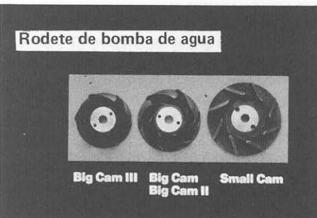
El modelo Big Cam NTC 475 lanzado en 1981 (SPT 81T1-9) requería el caudal mayor propio de los motores Big Cam I y II. En efecto, este diseño exigía aumentar el caudal de refrigerante por el núcleo del posrefrigerador y el bloque, en orden al adecuado enfriamiento del motor. Para lograr este mayor caudal fue preciso emplear el rodete de 4 1/2".
