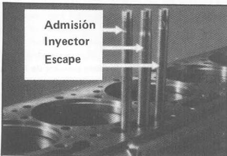
Los tubos empujadores de las válvulas de admisión y escape son normalmente idénticos, pero el tubo empujador del inyector es un poco más GRUESO, lo cual le confiere más resistencia. Esta resistencia adicional es necesaria porque se requiere más presión para inyectar el combustible que para abrir las válvulas.
