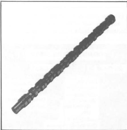
El árbol de levas es el principal órgano de gobierno del motor, ya que regula la apertura y cierre de las válvulas y la distribución de la inyección. El árbol de levas trabaja estrechamente sincronizado con el cigüeñal y ejerce una revolución por cada dos de éste.
